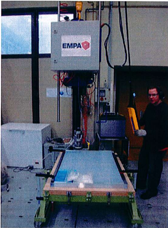
Bild 1: Versuchsanordnung mit Probenaufbau, Vorbehandlung der Oberfläche durch Kühlen
