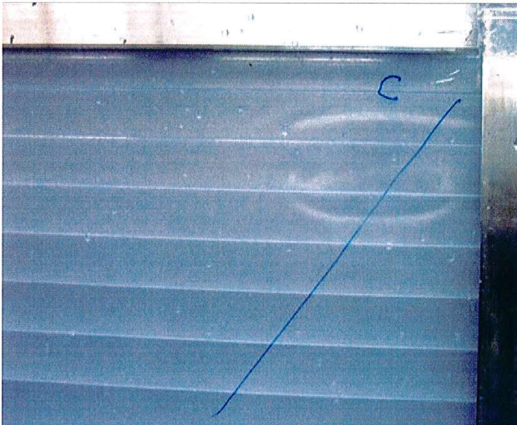
Bild 3: Visueller Effekt nach Eckenbeschuss mit 50 mm Eiskugel
