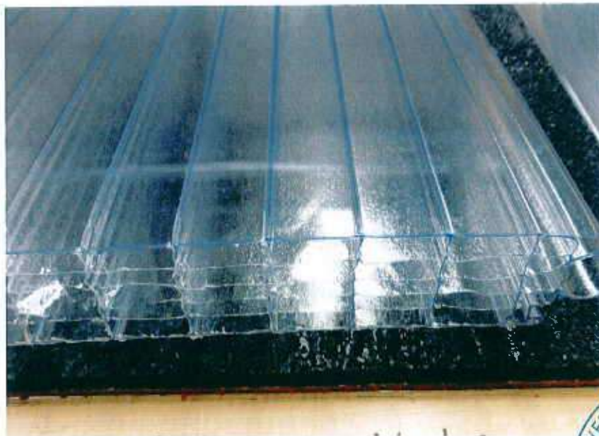
Bild 2 Ansicht: Schnitt Wandverglasung „PC 1540-6 / 2540-6 / 3540-6 Kristall
